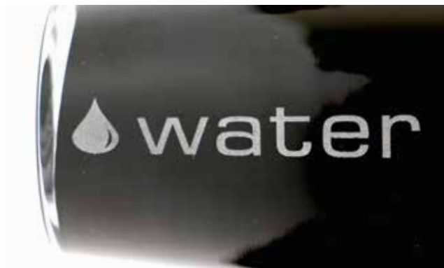
Laserem gravírované sklenice za pomoci rotačního zařízení
