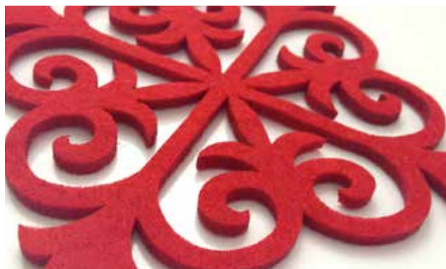
Čisté a dokonale uzavřené okraje textilií řezaných laserem
