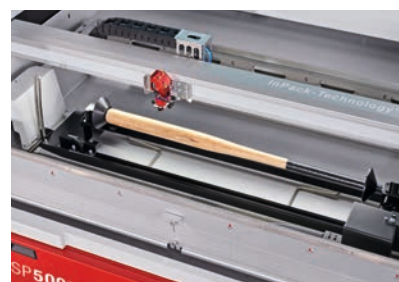
Gravírování válcových předmětů do délky až 1040 mm
